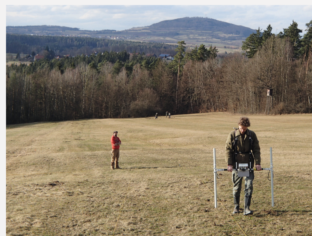
Magnetometerprospektion mit dem Gradiometer. Foto: N. Ostermeier
