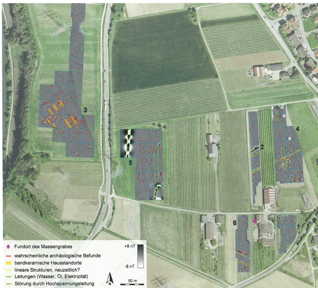
42 Talheim. Magnetogramme der Prospektionsflächen mit interpretierender Umzeichnung. Dual-Fluxgate-Gradiometer Bartington Grad 601-2, Dynamik \pm 8 nT in 256 Graustufen, Messpunktdichte 12,5 \text{ cm} \times 50 \text{ cm} (interpoliert auf 12,5 \text{ cm} \times 25 \text{ cm} ), 20–30-m-Gitter. Hintergrund: Digitales Orthofoto.
