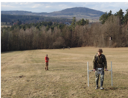
Abb. 4: Mitarbeiter der Uni Würzburg bei der Prospektion mit dem Gradiometer. Foto: N. Ostermeier.
