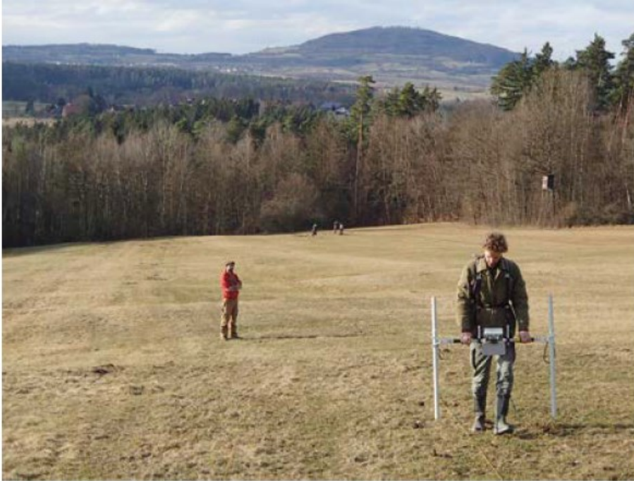
Magnetometerprospektion mit dem Gradiometer (Foto: Nils Ostermeier)
